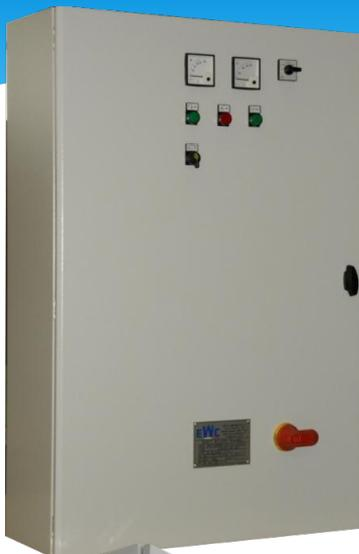
**Quadro elettromeccanico trifase soft start; Contattore e soft-starter per avviamento motore; Contattore di by pass; Autoritenuta (escludibile da selettore);**
